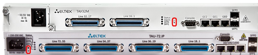
Рисунок 3.3 – Положение функциональной кнопки F
