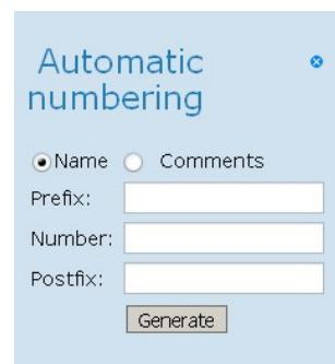
При установленном флаге «*Name*» или «*Comments*» значения, указанные в полях «*Prefix*», «*Number*», «*Postfix*» автоматически пропишутся в соответствующих полях всех портов.
