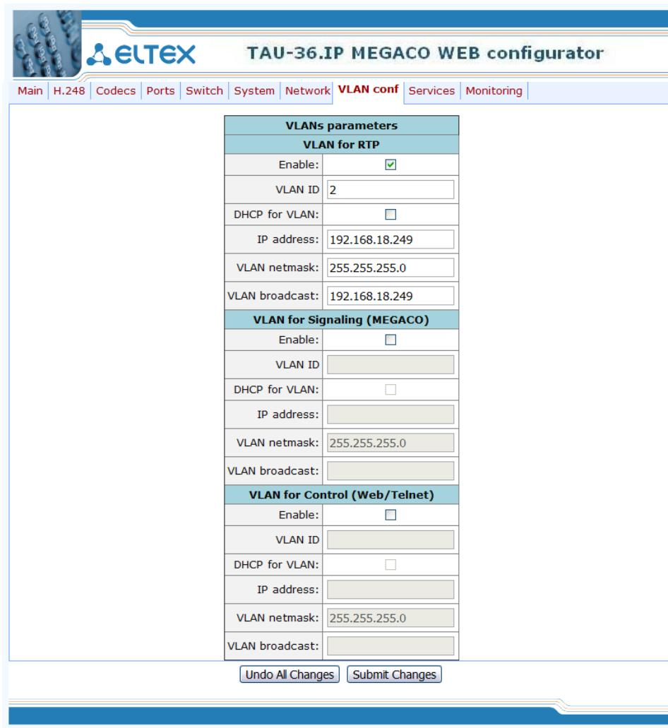
В разделах **VLAN for RTP**, **VLAN for Signaling**, **VLAN for Control** можно сконфигурировать от одной до трех сетей VLAN:
