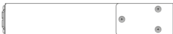
Рисунок 2.9– Левая боковая панель маршрутизатора ESR-100, ESR200
