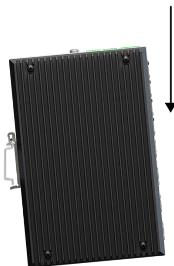
Рисунок 103 – Первый этап инсталляции MES на DIN-рейку
