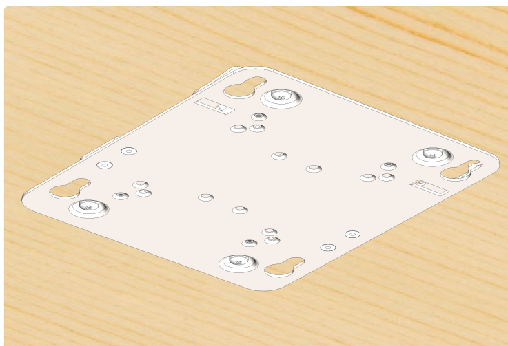
Рисунок 9 — Крепление монтажной пластины на поверхность
