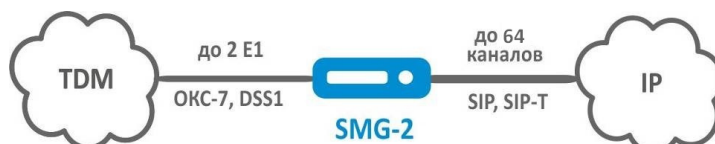
Рисунок 2 – Сопряжение сигнализаций и медиапотоків TDM- и VoIP-сетей с использованием SMG-2
