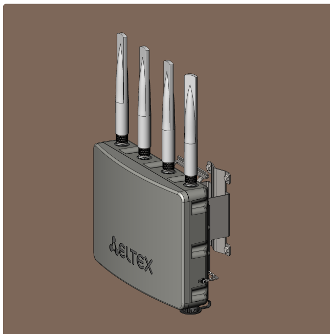
Рисунок 17 — Крепление устройства на стене
