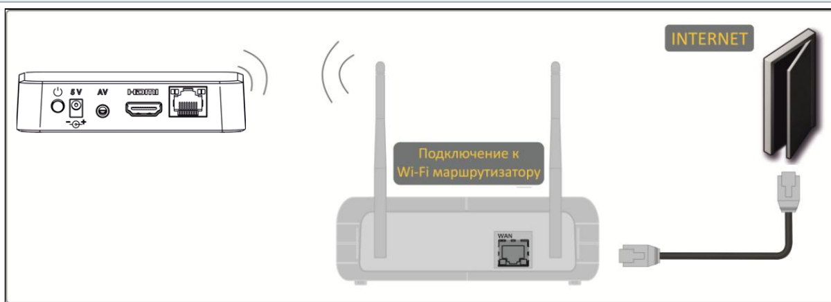
Рисунок 12 — Подключение к сети провайдера, используя Wi-Fi маршрутизатор
