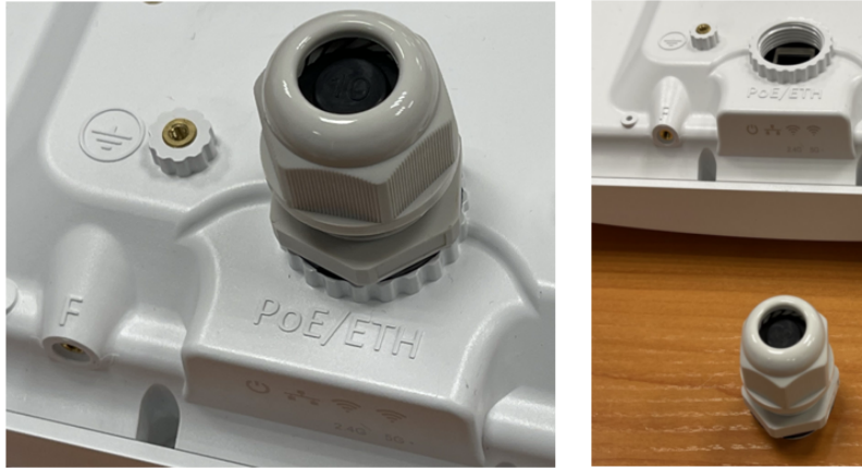
Рисунок 15 — Снятие кабельного ввода
