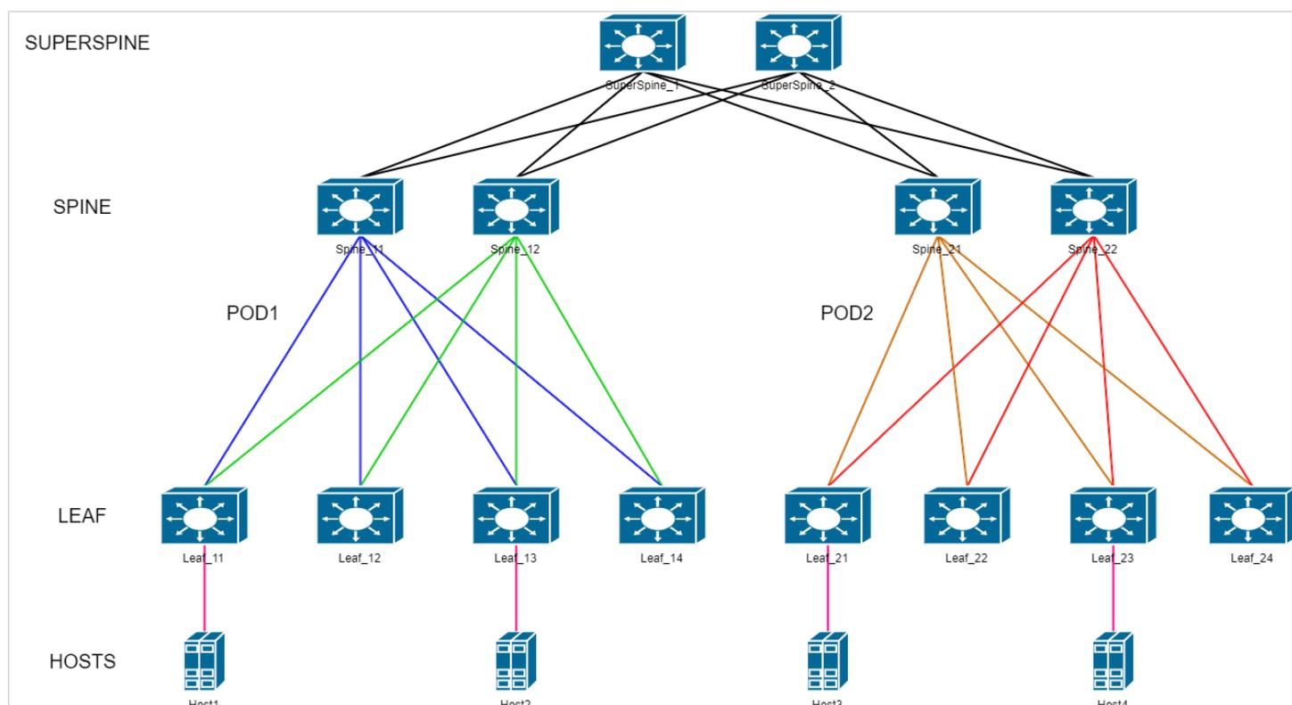
Появилось разделение на POD (см. [Используемые термины и сокращения](#)) и дополнительный уровень коммутации – SuperSpine или Spine второго уровня. Данная IP-фабрика состоит из двух POD. На схеме видно, что POD обособлены друг от друга – у Spine первого уровня (на схеме это устройства Spine\_11-22) есть соединения только с определенной группой Leaf-Leaf-ами своего POD. Связь между POD осуществляется через Spine второго уровня.
