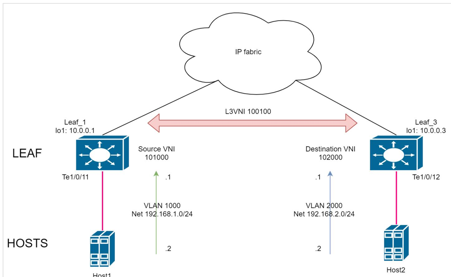
На устройстве Leaf\_1 уже создана VXLAN с VNI 101000 и VLAN 1000. Необходимо добавить ip-интерфейс VLAN 1000 в VRF1, чтобы для маршрутизации пакетов клиента использовалась L3VNI. Затем назначить на этот ip-интерфейс ip-адрес.
