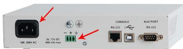
Задняя панель мультиплексора ToPGATE (8E1-2FG)
