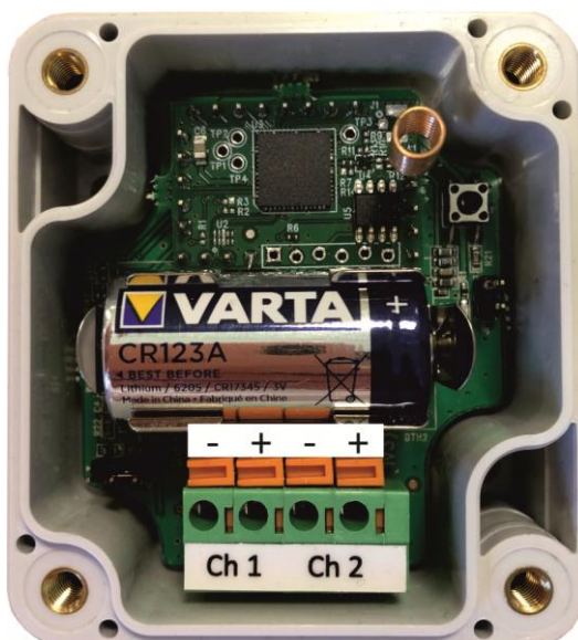
Рисунок 4 – Нумерация контактов SZ-W02
