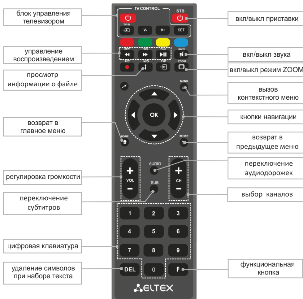
Рисунок 6 – Инфракрасный пульт для управления медиацентром и телевизором
