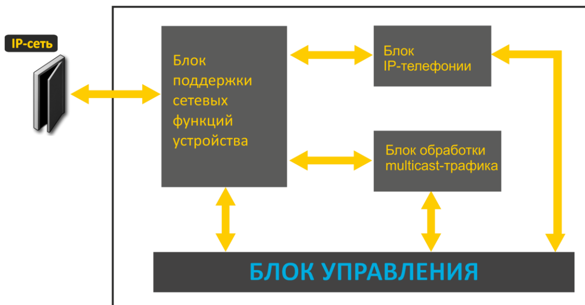
Рисунок 3 – Функциональная схема устройства серии TAU-4M.IP
