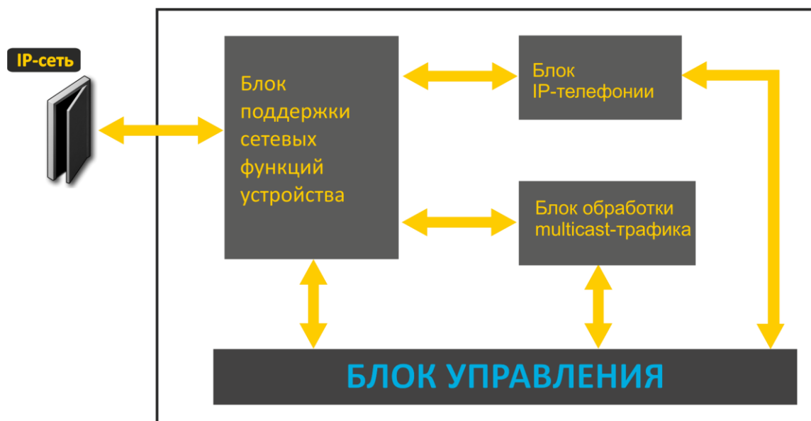
Рисунок 3 – Функциональная схема устройства серии TAU-2M.IP
