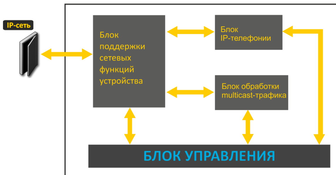
Рисунок 3 – Функциональная схема устройства серии TAU-1M.IP
