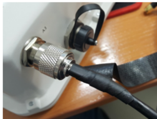
Герметизация разъема N-типа
