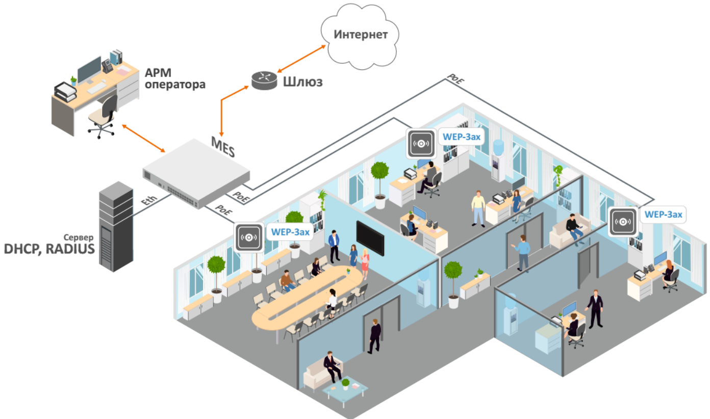
Рисунок 1 – Функциональная схема использования WEP-3ax, WEP-3ax-Z
