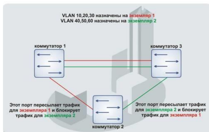
Рисунок А.1 – Настройка протокола множества связующих деревьев
