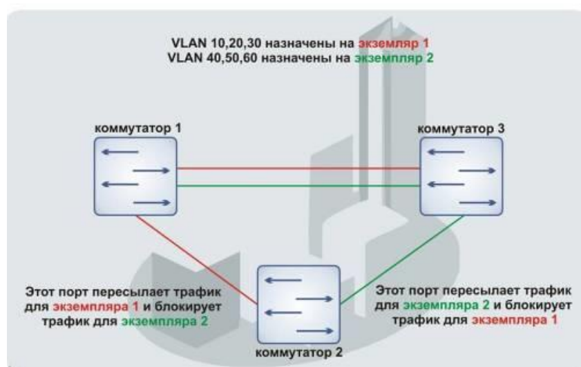
Рисунок А.1 – Настройка протокола множества связующих деревьев
