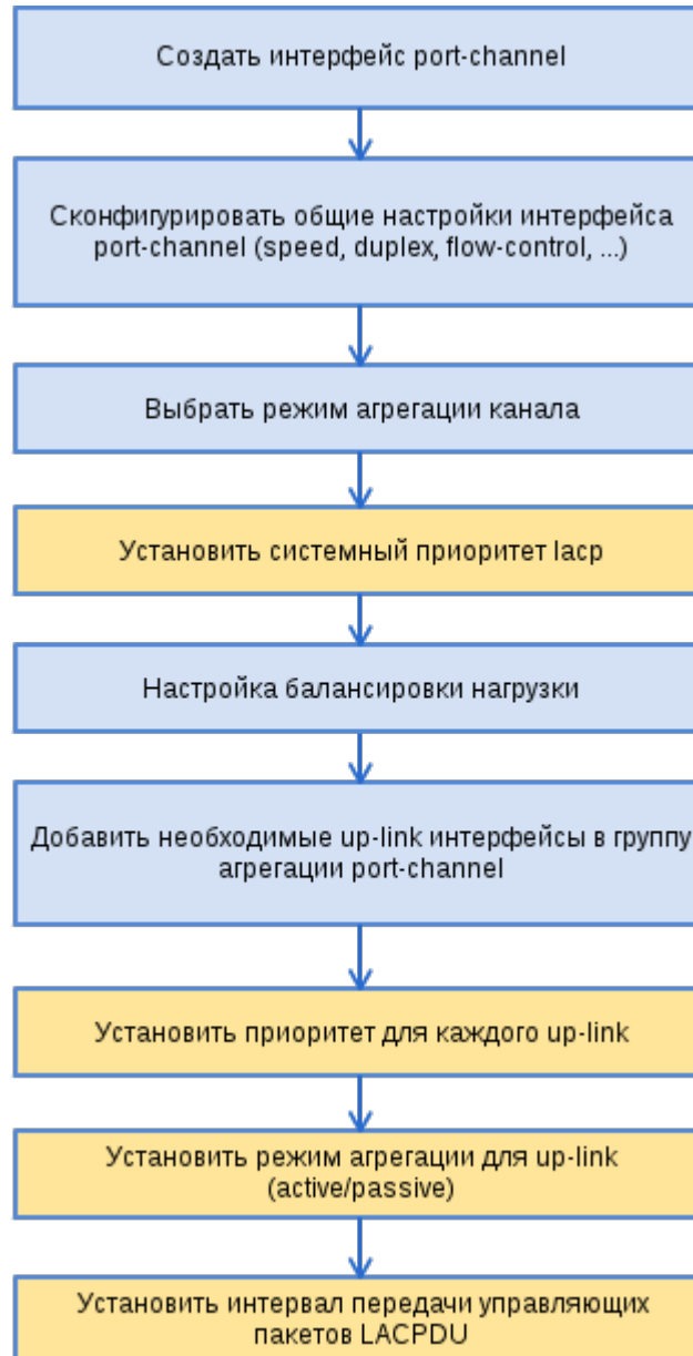
Рисунок 28 — Последовательность настройки LAG и LACP
