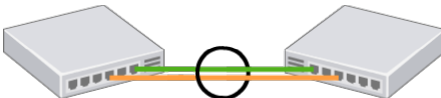
Рисунок 27 – Объединение нескольких физических каналов в группу агрегации
