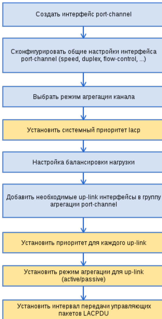
Рисунок 28 – Последовательность настройки LAG и LACP
