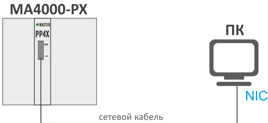
Рисунок 17 – Подключение узла доступа к компьютеру сетевым кабелем
