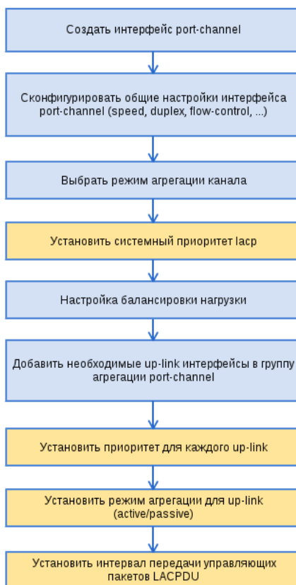
Рисунок 27 – Последовательность настройки LAG и LACP
